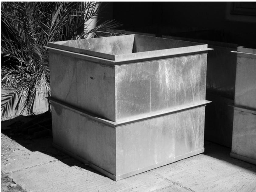
Figure 13 : Bac d'évaporation cubique de 1m d'arête (enterré) utilisé dans la station météorologique d'Erfoud
