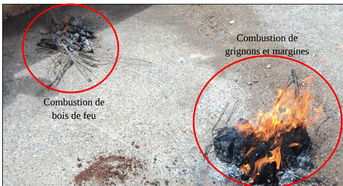
Photo 5 : Comparaison entre la combustion du bois et du nouveau produit
