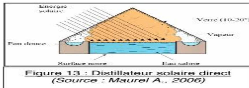
Figure 14: Distillateur solaire direct (source : Maurel A., 2006)
