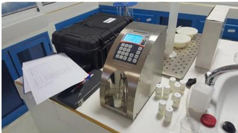
**Figure 9:** Milk Analyzer Master pro. Utilisé pour l'analyse du lait
