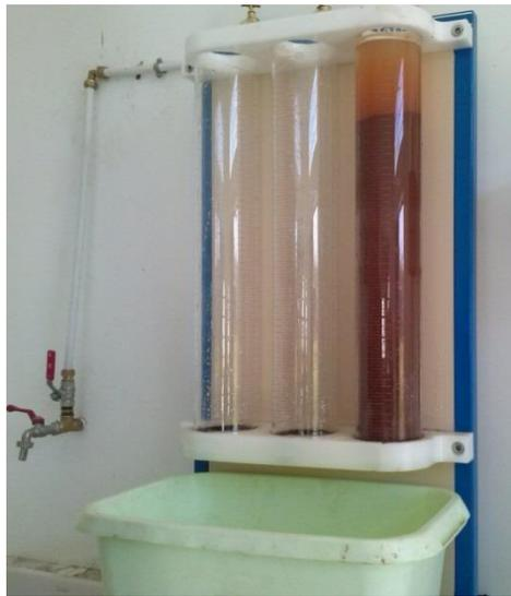
Figure2. 5: appareil de démonstration de l'infiltration
