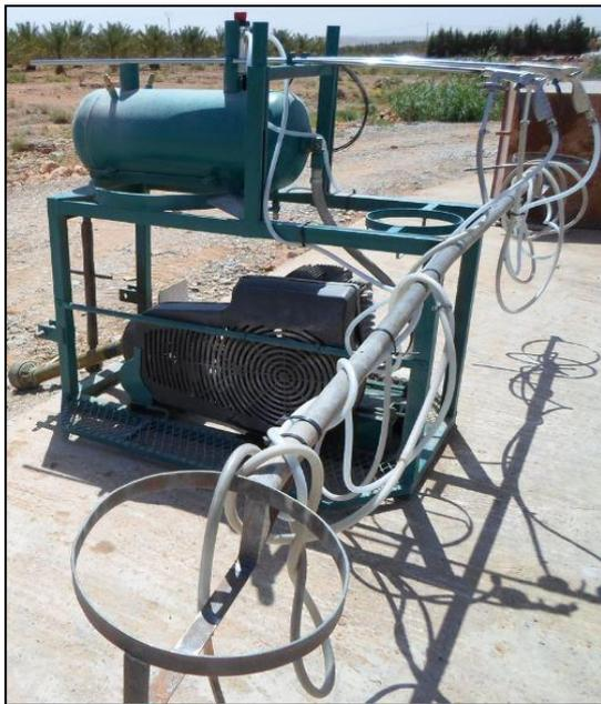
Figure 11: Machine de la pollinisation mécanique
