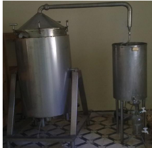
Chauffage assurée par injection de vapeur surchauffée produite séparément (photo de l'auteur, 2010)
