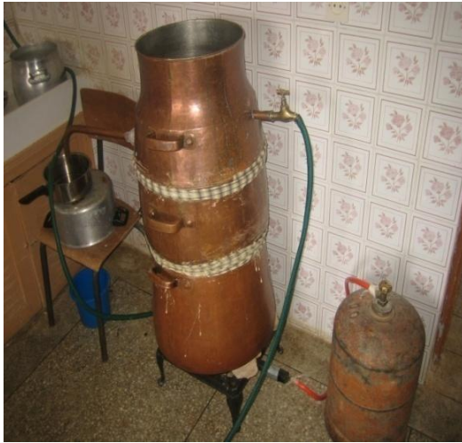
Chauffage direct (photo de l'auteur, 2010)
